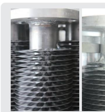
エロフィンチューブは熱交換器用の伝熱管の一種であり、放熱面積を増やすため、パイプの外周にフィン（帯状の金属板）をらせん状に巻きつけて加工したものです。
